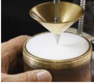
주도 (혼화주도)는 그리스 (페이스트)의 딱딱함 정도를 나타내는 수치.시료를 규정 혼화기에서 25℃를 유지하고 60회 왕복혼화(전단)한 직후에, 규정 원추가 규정시간에 시료에 진입하는 깊이(mm)를 측정하고, 이 깊에 10배를 곱하여 산출합니다.따라서, 혼화주도의 수치는 크면 클수록 부드러운 그리스(페이스트)가 됩니다.NLGI No. 는 혼화주도를 기초로 하여 오른쪽표와 같이 정하고 있습니다. 따라서 NLGI No. 의 수치가 크면 클수록 딱딱한 그리스가 됩니다.
